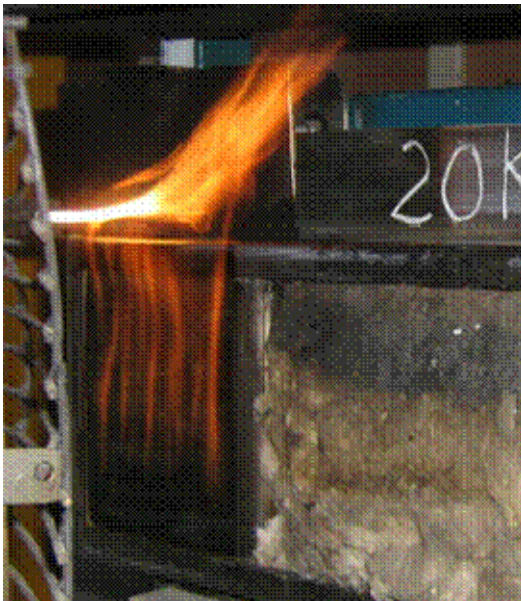
Fotografía 3 Vista de una probeta durante el ensaye, tras producirse la ignición
