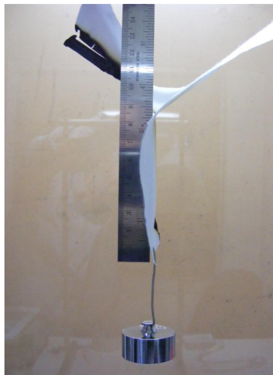
Fotografía 12: Prueba de desgarro probeta N°6.
