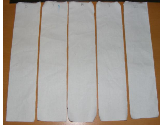
Fotografía 2: Probetas 6 a 10 tratadas con AF7000 antes del ensayo.
