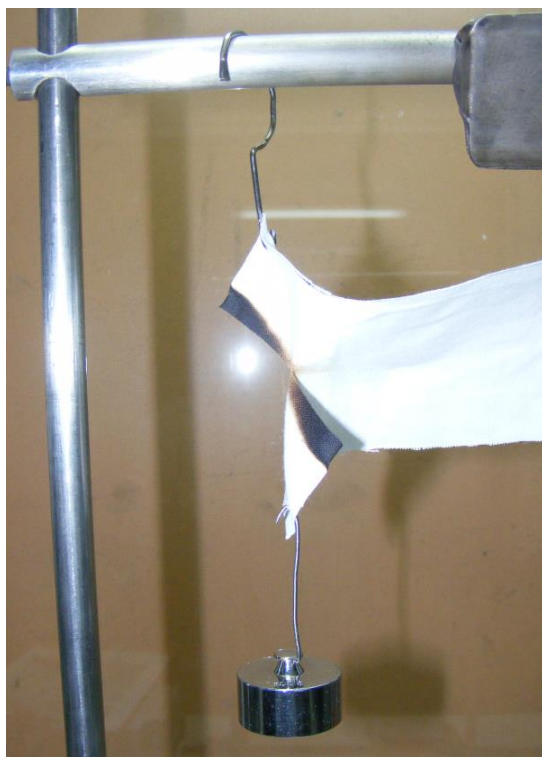
Fotografía 11: Prueba de desgarro probeta N°1.
